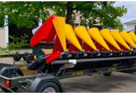
Die leichten Hauben lassen sich für den Transport auf der Straße hochklappen und arretieren sicher in den Halterungen. Den CORN MASTER gibt es auch als schwarze Maschine. The new lightweight plastic hoods are very easy to fix for transportation on the road and lock securely in their holders. The CORN MASTER is also available as a black machine.
